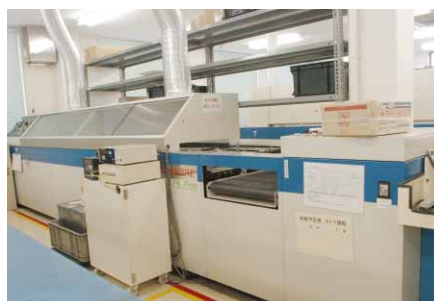
図1 独自の技術を投入した鉛フリー対応のハンダ槽(特許出願中)
