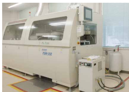
図1 独自の技術を投入した鉛フリー対応のハンダ槽(特許出願中)
